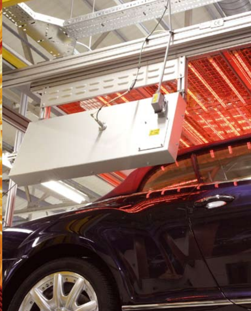
红外线加热使敞篷车顶篷毫无褶皱。
