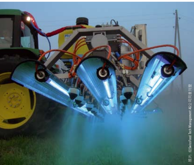
Phyt03机器正在运作: 紫外线灯装在拖拉机附加装置内。
