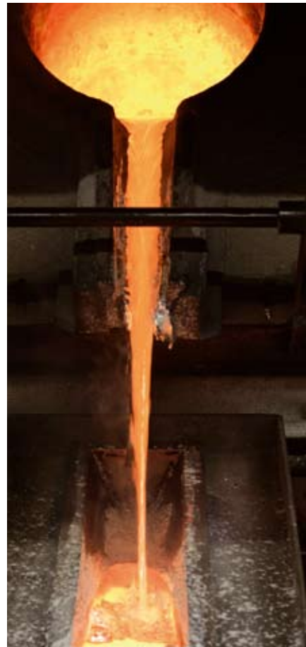
浇注贵金属熔液来制造高纯度颗粒。
