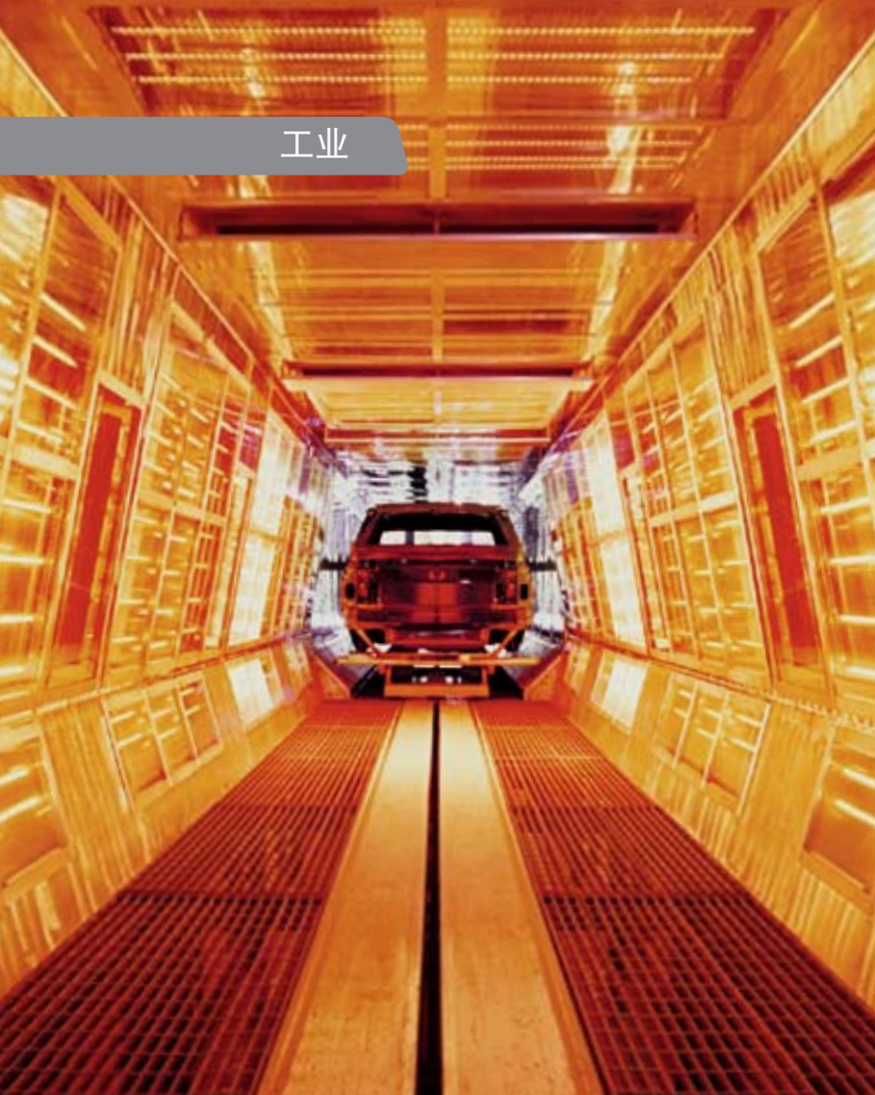
用隧道式加热炉来烘干车身油漆。
