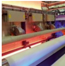
在安全气囊的布料纤维上，使用了硅胶涂层。
